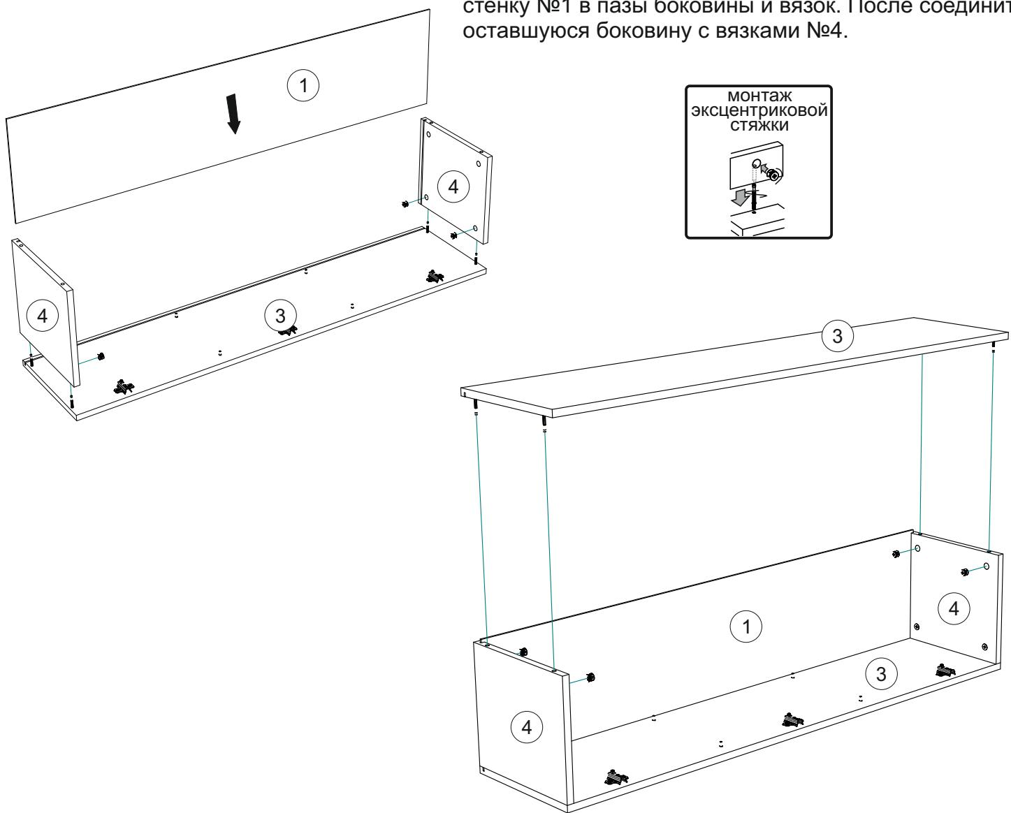
**4.** Используя соединители RV-8 и шурупы 4x16 закрепите заднюю стенку №1.
